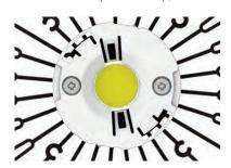
旋转灯座,让螺丝进入散热片上的安装孔。 拧紧螺丝(最大扭矩0.5 Nm)。
