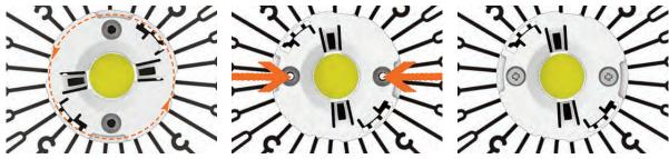
旋转灯座,让螺丝孔与散热片上的孔相匹配。 插入螺丝并拧紧(最大扭矩0.5 Nm)。
