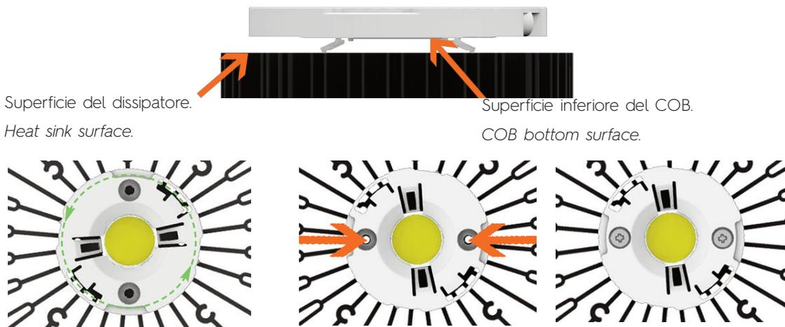
Ruotare l'holder finché i fori per le viti si sovrappongono ai fori previsti nel dissipatore.
