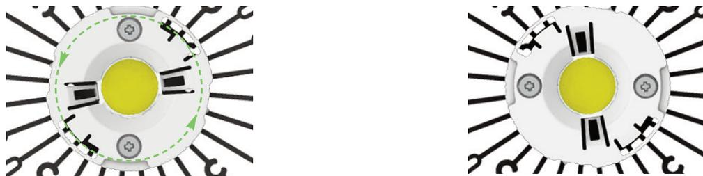
Ruotare l'holder finché le viti non si posizionano nei fori previsti nel dissipatore.
